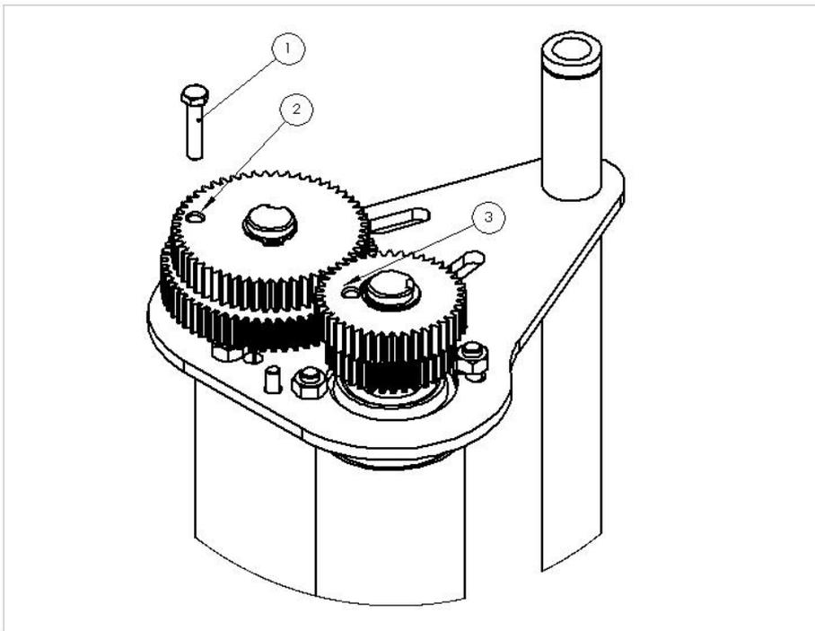
Si le boulon (1) est à l'emplacement 2, l'étirage du film est déterminé par le jeu d'engrenages inférieur (70 %).
