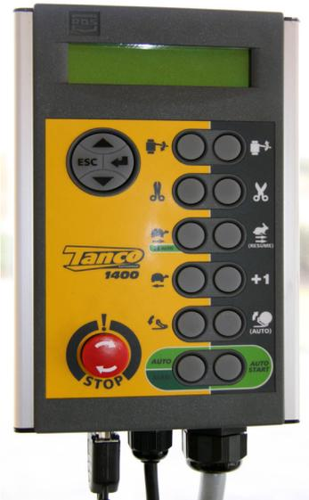
L'unité de commande comporte un bouton d'arrêt d'urgence, un câble de commande, un fusible et un câble de batterie. Elle doit être fixée à un endroit approprié dans la cabine du tracteur à l'aide de la ventouse fournie.
